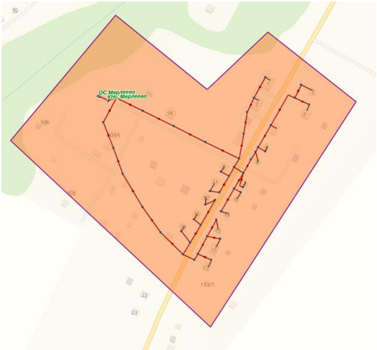
Рисунок 3.1.5.1.10 – Схема системы водоотведения д.Мерлеево
