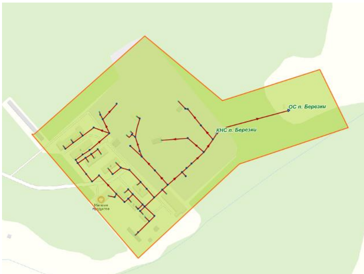
Рисунок 3.1.5.1.18 – Схема системы водоотведения п.Березки
