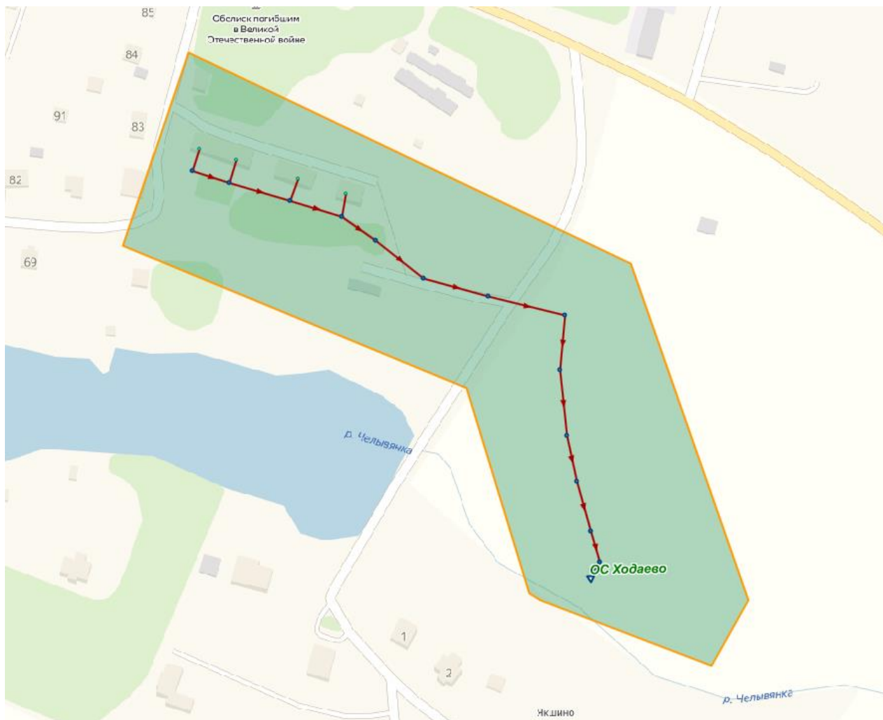
Рисунок 3.1.5.1.9 – Схема системы водоотведения д.Ходаево
